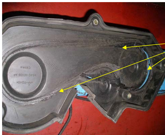
Fig. 3 Serias señales de abrasión en el interior de la tapa debido al contacto lateral de la correa
