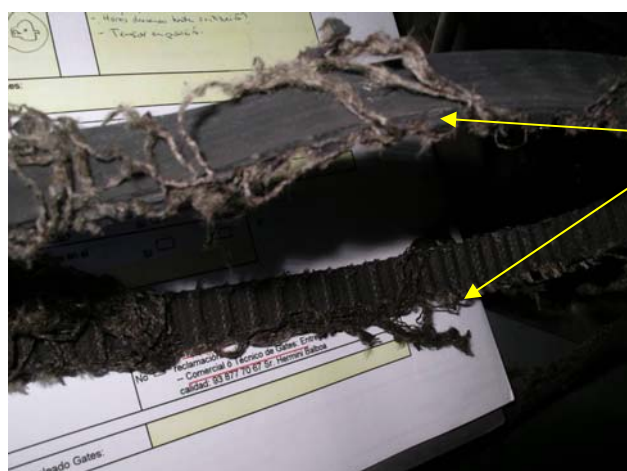
Рис. 2 Типичный износ боковой части ремня.
