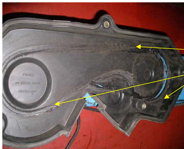
Рис. 3 Признаки сильного износа на внутренней части кожуха вследствие контакта с боковой поверхностью ремня.
