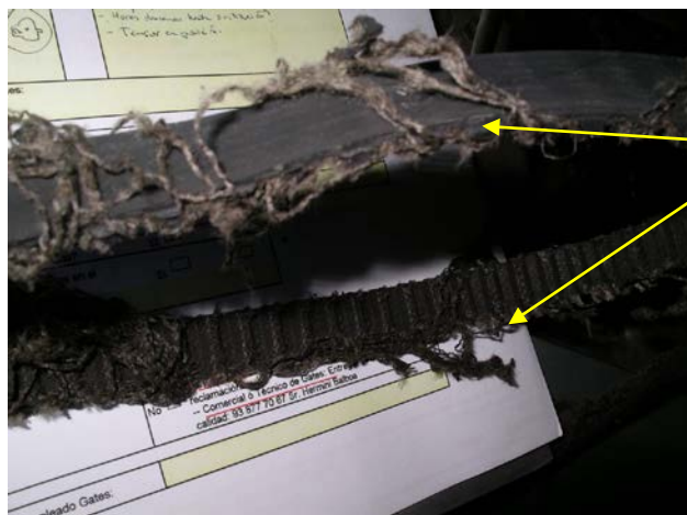
Fig. 2 Modèle d'usure typique sur le rebord de la courroie
