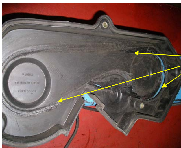
Fig. 3 Sérieux signes d'usure sur l'intérieur du cache, dus au contact avec la tranche de la courroie
