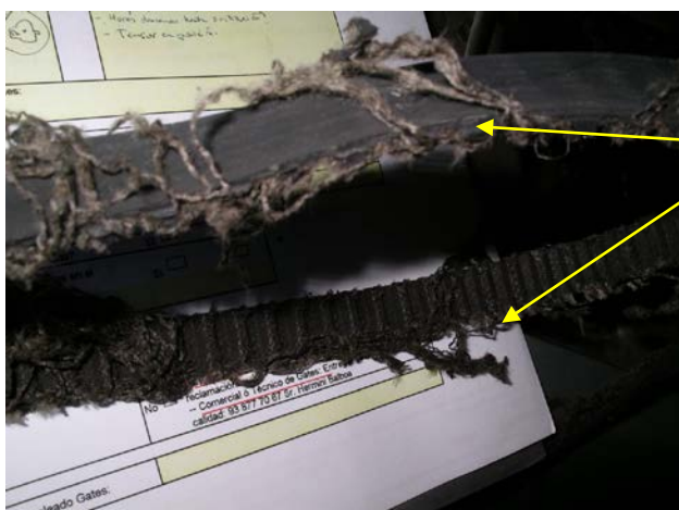
Fig. 2 Typiskt slitage på en sida av remmen
