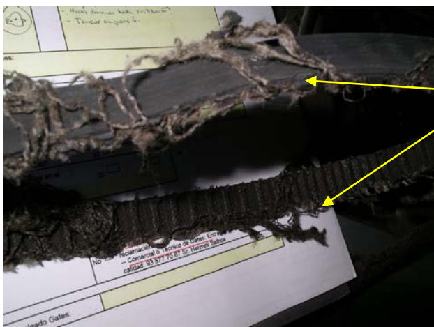
Fig. 2 Típico patrón de desgaste por el lado de la correa
