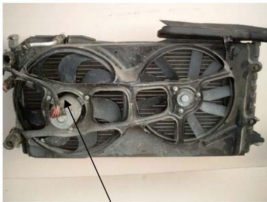
Fig. 1: Electrically driven fan
