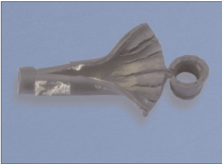
Koelslangen kunnen beschadigd raken door elektrochemische degradatie (foto links), slijtage (foto rechts) en hitte (foto onder)
