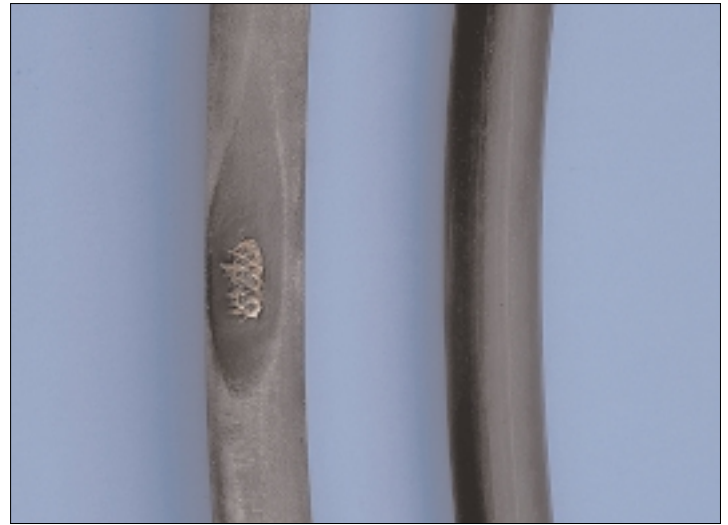
Koelslangen kunnen beschadigd raken door elektrochemische degradatie (foto links), slijtage (foto rechts) en hitte (foto onder)
