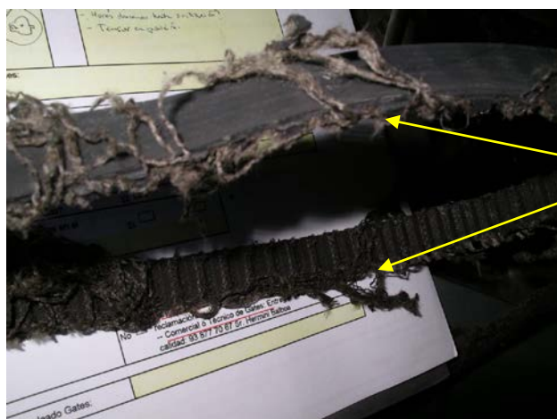
Fig. 2 Typisch slijtagepatroon aan de zijkant van de riem
