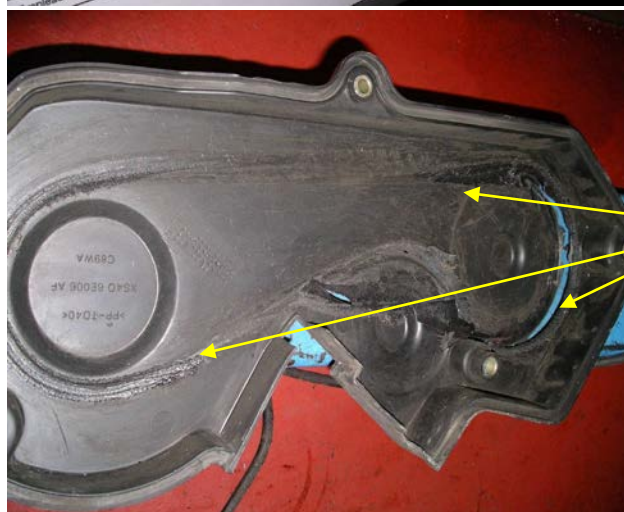
Fig. 3 Indicatie van ernstige slijtage aan de binnenzijde van de kap door contact met de zijkant van de riem
