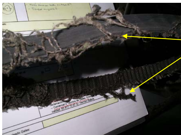
Rys. 2 Typowe oznaki wytarcia na boku paska
