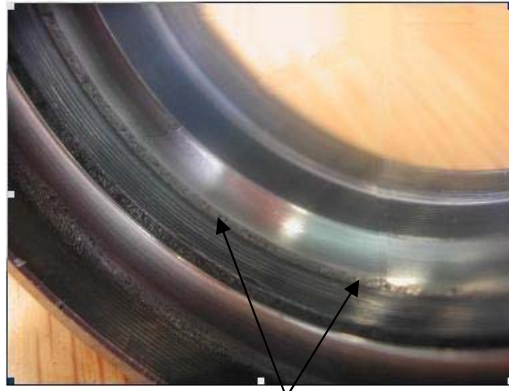
Abb. 4 Anlaufspuren der Lagerkugeln
