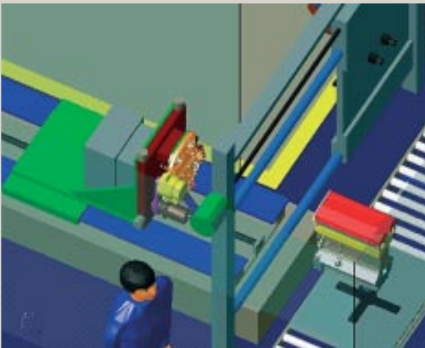
Bild 9: „Shuttle“-Fördersystem: Die Montagestation (Mitte) kurz vor der Montage des Moduls an den Motor; das Shuttle ist oben rechts sichtbar
