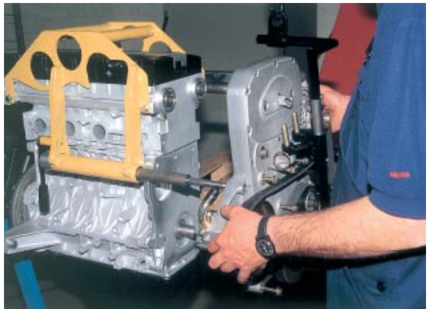
Bild 1: Das erste GEM10-Modul, vorbereitet zur Endmontage an den Motor Figure 1: The first GEM10 module ready to mount to its engine
