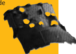
PSV-400 Geometrie-Scan eines Getriebegehäuses
