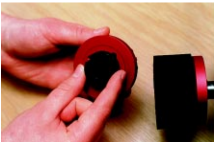
Mise en place du moyeu amovible dans l'extrémité
