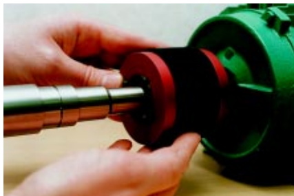
Mise en place des vis et fixation sur l'arbre
