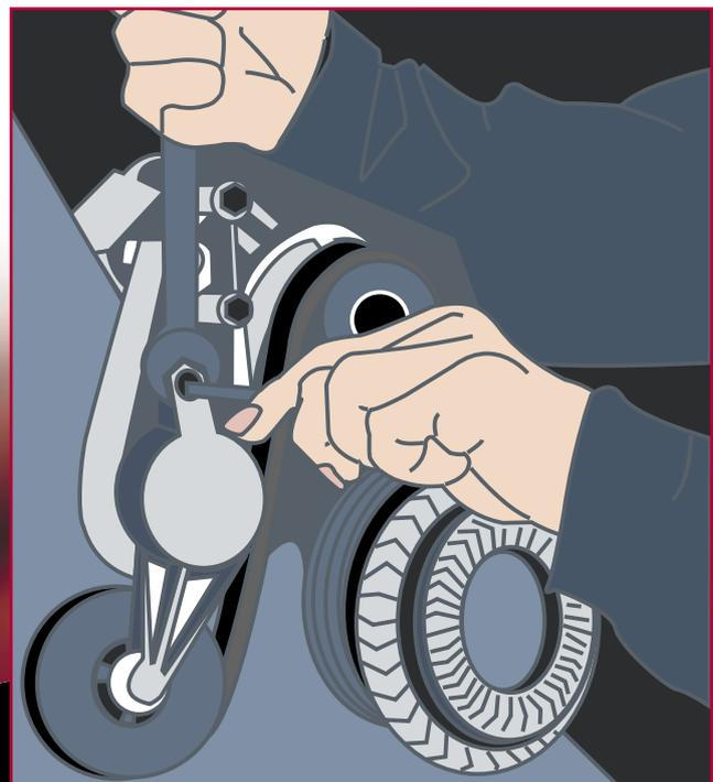
Compruebe siempre el estado del tensor automático. Si no funciona correctamente, reemplácelo por un tensor DriveAlign® de Gates. Para más información sobre tensores DriveAlign® de Gates, consulte el folleto E4/70380 o catálogo E/70378.
