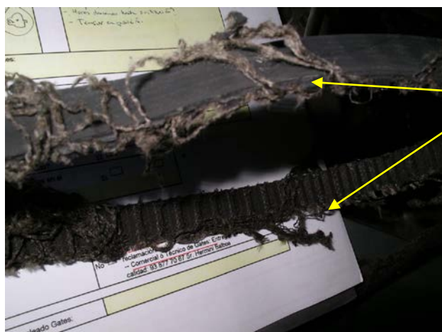
Kuva 2. Tyypillinen esimerkki kulumisesta hihnan reunassa.
