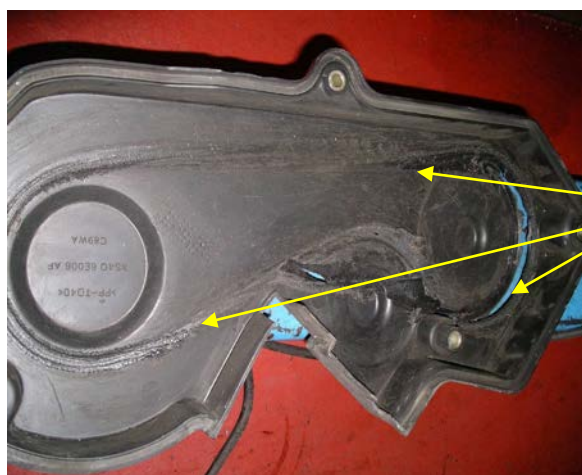
Fig. 3 Severi segni di logorio all'interno della calotta causati dal contatto con il lato della cinghia
