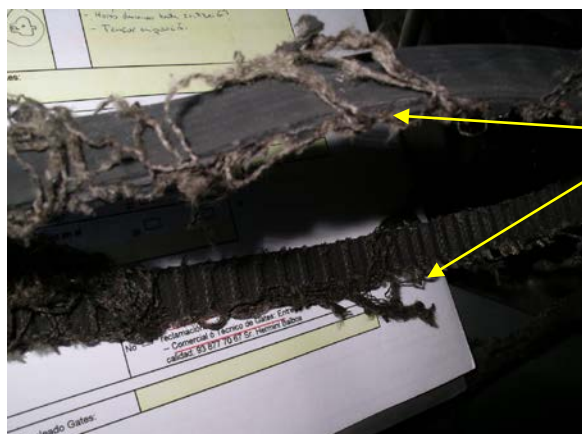
Fig. 2 Tipico segno d'usura sul lato della cinghia
