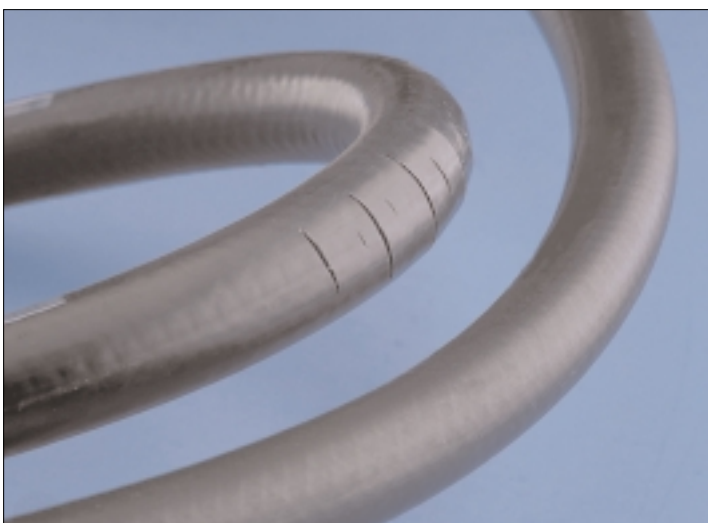
L'ozone (photo à gauche en dessous), l'huile (photo à droite) et les fuites (photo à droite en dessous) peuvent aussi entraîner l'usure des tuyaux
