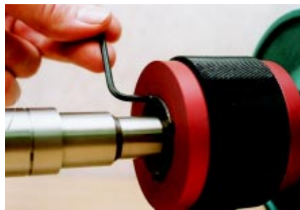
Schrauben abwechselnd gleichmäßig anziehen
