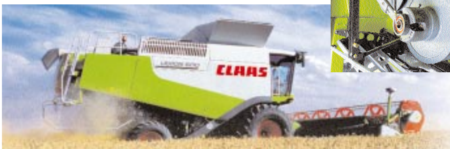
Im neuen Claas Lexion 600 kommen unter anderem Breitkeilriemen der neuesten Generation von Gates am Variatorantrieb der Dreschtrommel zum Einsatz.
